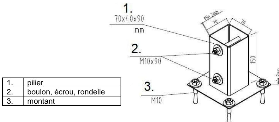
Placez les montants pour piliers sur les extrémités des piliers et déplacez la maison à l'emplacement désiré. Faites des trous dans la surface de base et attachez les montants avec des boulons d'ancrage. Pratiquez des trous dans les piliers en bois et attachez avec des boulons.
