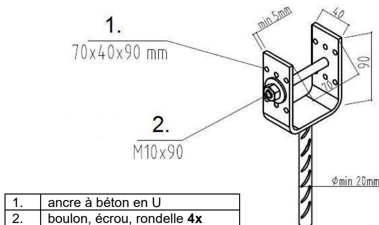
Creusez un trou pour chaque support (consultez une entreprise de construction locale), remplissez-les de béton et placez les ancre à béton dans les points précisément mesurés. Assurez-vous que toutes les ancre à béton en U sont à la même hauteur ! Laissez suffisamment de temps au béton pour qu'il durcisse. Après cela, placez la maison dans les ancre et attachez avec des boulons.
